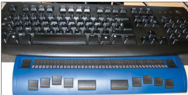
Braillova vrstica, ki slepim nadomešča računalniški zaslon
