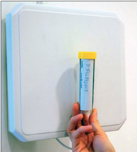
RFID-sprejemnik in RFID-nalepka na tulcu
